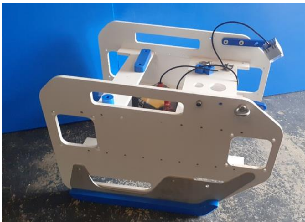
Figure 14 - Le NEEZO et son portique homologué CMU 250 kg et notre nouvelle caméra tractée CAT80 Evo
